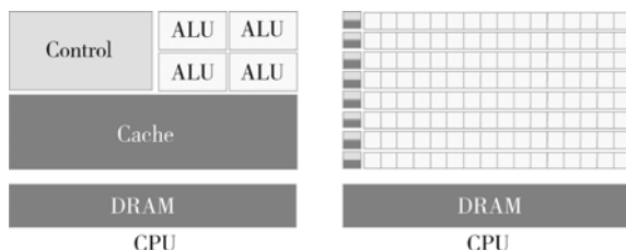
图1 GPU将更多晶体管直接用于数据运算
